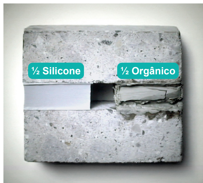
Figura 2. Comparativo de um selante de silicone x orgânico após teste de intemperismo artificial
