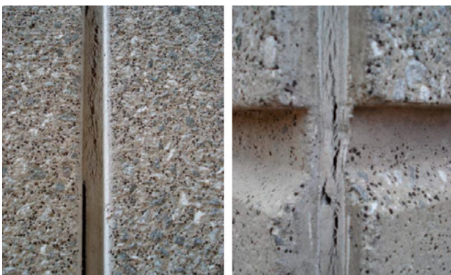
Figura 6. Exemplos de falhas adesivas e coesivas
